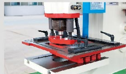
冲孔工位 Punching station
